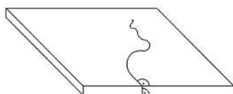
Fissure thermique normale
