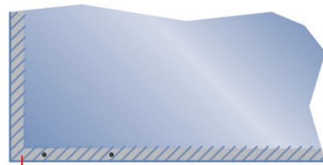
**3** Vitrage isolant : le revêtement sert de boucle d'alarme non visible et est contrôlé par une unité de lecture
