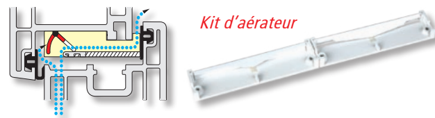
Aérateur en feuillure REGEL-air ® pour fenêtres PVC
