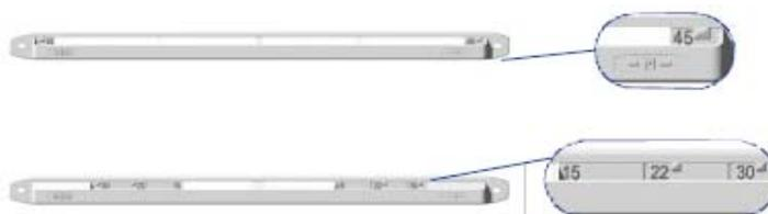
Entrée d'air M 45 m<sup>3</sup>/h ; le débit de l'entrée d'air est indiqué sur les 2 clips
